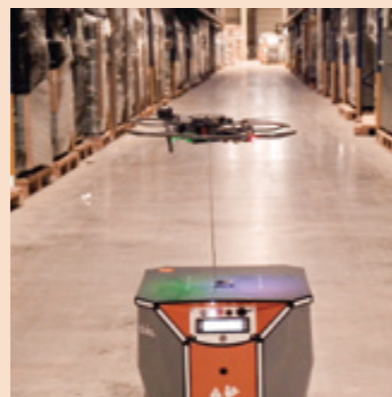
完全自動運転するドローンとAGVを有線給電でつなぎ、5時間稼働できる
